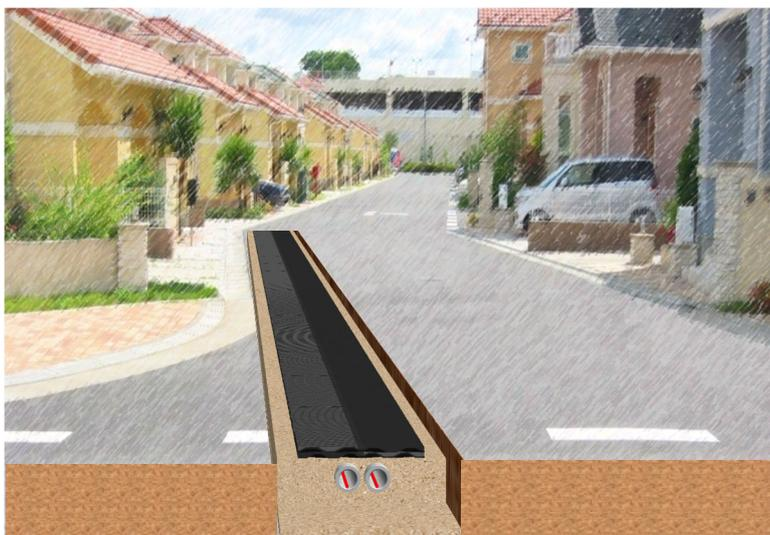
H28年に埋設深さの基準緩和から、「浅層埋設」や「小型ボックス活用埋設」といった低コスト整備が可能となりました。その中でも、直接埋設方式は、浅層埋設による管路や小型ボックス等の電線類の收容部材が不要、既設埋設物との干渉が減少するメリットのある、最も低コストな手法です。
